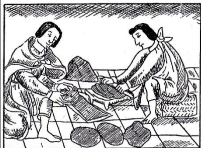
Figura 111. Los orfebres aztecas confeccionaban sus moldes mezclando barro y carbón molido. La metalurgia azteca, sin embargo, no estaba muy desarrollada. (Códice Florentino).
